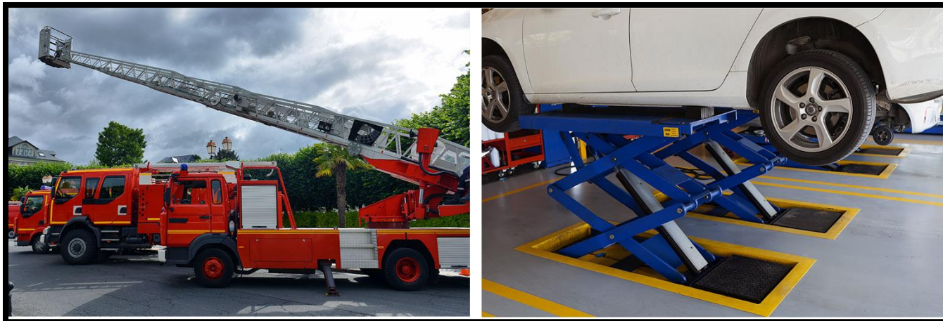
Imagen 2: Aplicaciones central hidráulica de alta presión
