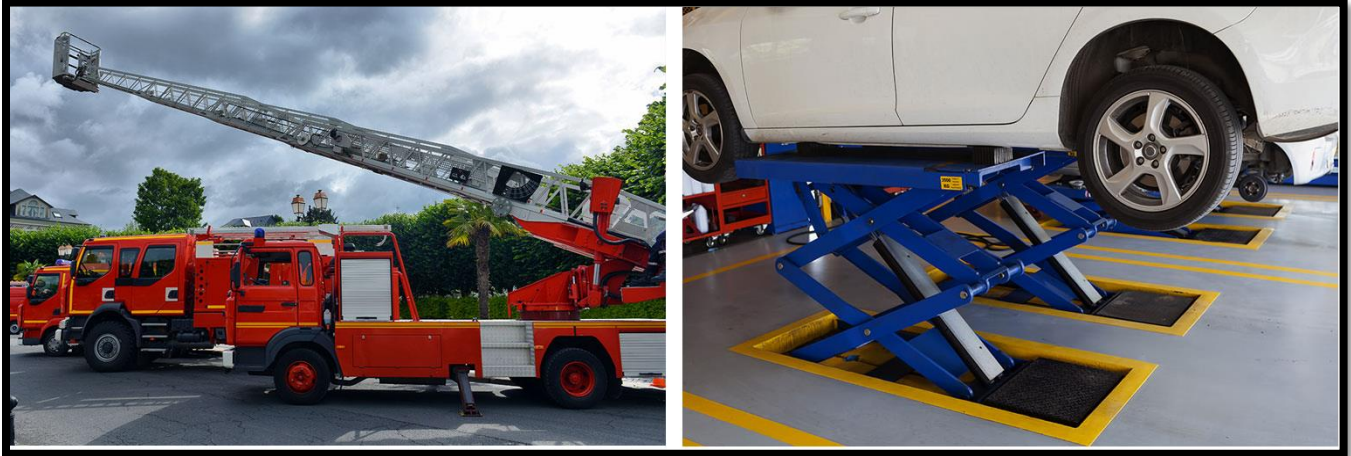
Imagen 1: Aplicaciones central hidráulica de alta presión
