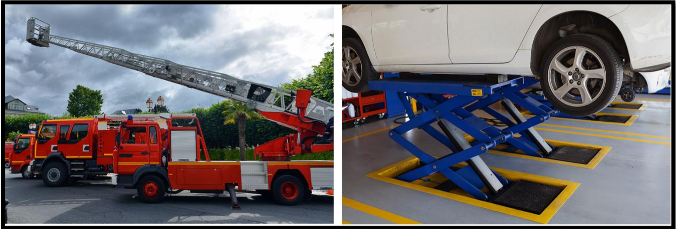
Imagen 1: Aplicaciones central hidráulica de alta presión
